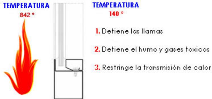
Figura 2. Aislamiento térmico
