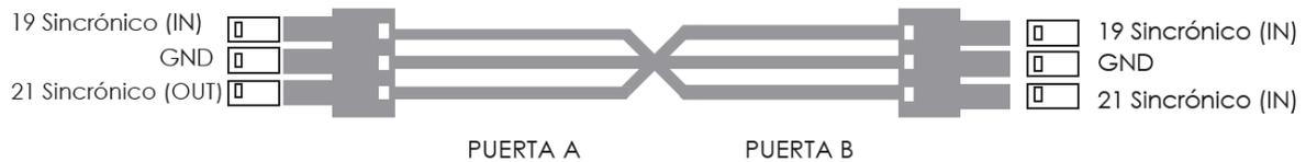
**Atención:** el controlador emitirá una alarma mientras la línea síncrona no se conecte o el zumbador de conexión no emita un pitido, los LED rojo y verde parpadearán 3 veces en 4 segundos
