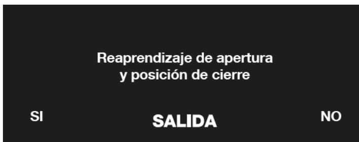
Presione el botón Sí para volver a reaprender las posiciones de apertura y cierre.
